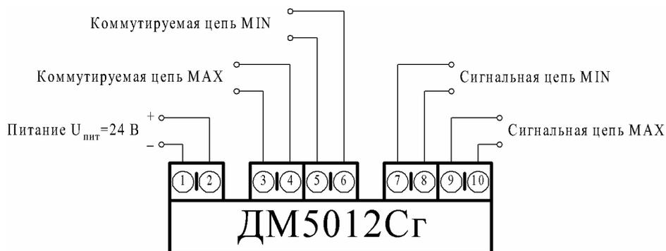
Рисунок В.1 Схема внешних электрических соединений.
