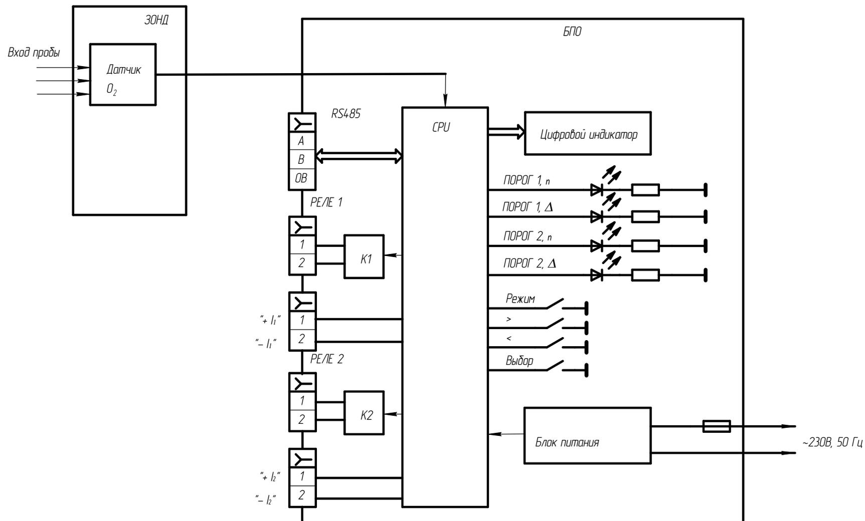
Рисунок 1.2 – Газоанализаторы АКВТ-02. Схема функциональная
