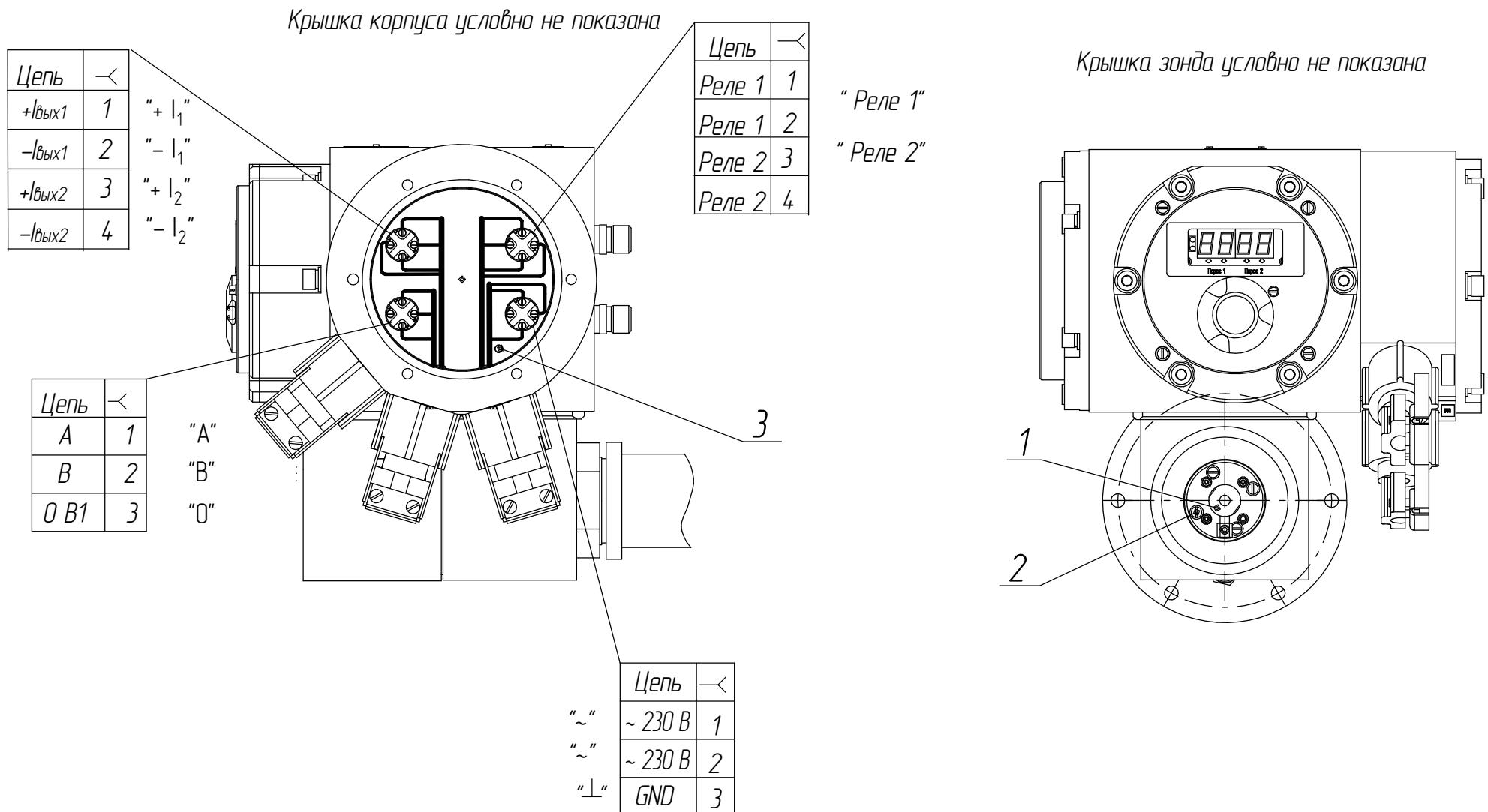
Рисунок 2.1 – Газоанализаторы АКВТ-02. Электромонтажный чертеж
