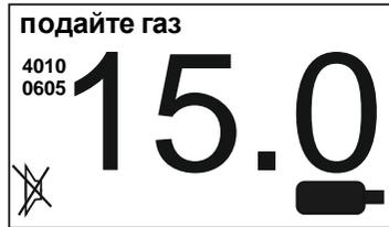
Изображение газового баллона в правом нижнем углу напоминает пользователю о том, что газоанализатор находится в режиме калибровки, число в середине экрана – значение концентрации рабочего вещества ПГС, которая должна быть использована для градуировки газоанализатора. (Этот параметр можно изменить при подключении газоанализатора с компьютером с помощью Bluetooth)
