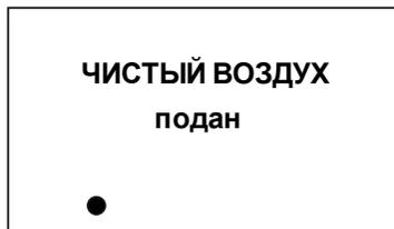
и начнется процесс установки нуля. Процесс продолжается около минуты, при этом точка снизу дисплея меняет свое положение, что показывает пользователю, что прибор находится в рабочем состоянии и не «завис».
