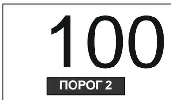
При индикации значений ПОРОГ 1 и ПОРОГ 2 происходит срабатывание звуковой, световой и вибросигнализации, с соответствующей интенсивностью вибрации, частотой звуковой сигнализации и частотой мигания светодиода.
