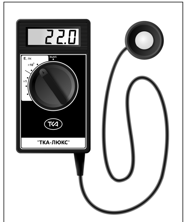
Рис. 2. Внешний вид прибора 1 – блок обработки сигналов, 2 – фотометрическая головка.
